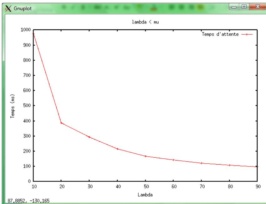
Lorsque  $\lambda$  est inférieur à  $\mu$ , plus  $\lambda$  croît, plus le temps de traitement est réduit car les paquets mettent moins de temps lors de leur traitement. Le temps d'attente moyen est donc exponentiellement décroissant.
