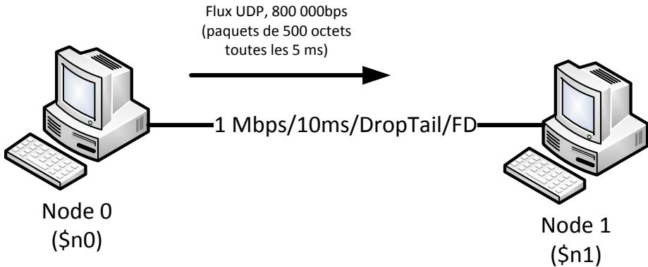
Pour cela, nous avons créé deux nœuds NS-2 ([node](#)), reliés par un lien full duplex ([duplex-link](#)) supportant un débit de 1Mbps, un temps d'accès au medium de 10 ms, et qui utilise l'algorithme de file d'attente DropTail<sup>2</sup> pour la gestion des congestions.
