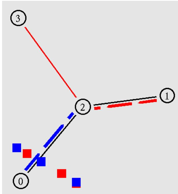
Lors de la rupture du lien entre les nœuds 2 et 3, la file d'attente est instantanément vidée car le destinataire (nœud 3) ne peut plus être contacté par le router/commutateur (nœud 2), et qu'il n'est donc pas nécessaire de stocker ces paquets qui ne pourront être transmis.
