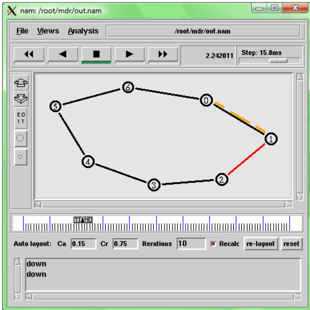
On remarque qu'en temps normal, les paquets émis par le nœud 0 à destination du nœud 3 sont routés en passant par les liens 0-1, 1-2 et 2-3. Lors de la rupture de lien entre les nœuds 1 et 2, la route n'est pas recalculée, ce qui provoque la perte de tous les paquets émis durant la rupture de lien, soit 2 secondes (400 paquets de 500 octets).
