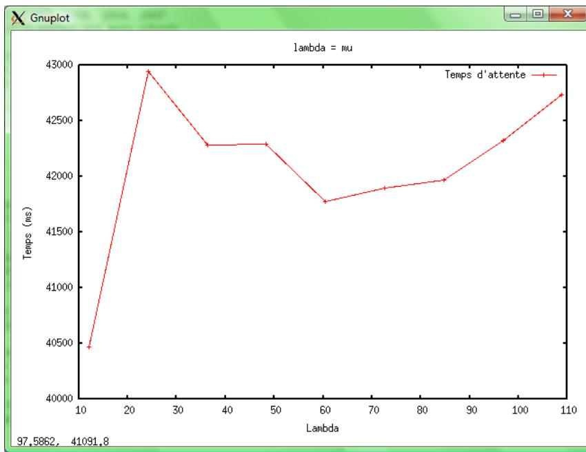
En revanche, lorsque lambda est supérieur à mu, on observe l'effet inverse : comme la taille des files d'attente augmente de façon constante en fonction de lambda, le temps de traitement réduit ne suffit pas à compenser la taille importante des files d'attente. Par conséquent, cette courbe est sensiblement logarithmique.
