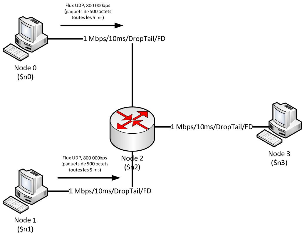
Soit deux nœuds émettant un CBR de 800 000 bps, à destination d'une machine écoutant ces deux CBR, en passant par un nœud (routeur ou commutateur) auquel les trois nœuds sont reliés. La congestion va se faire entre le routeur/commutateur et le nœud destination, car le lien est limité au mieux à 1 Mbps alors que la somme des CBR émis à sa destination est de 1 600 Kbps, donc plus élevé.
