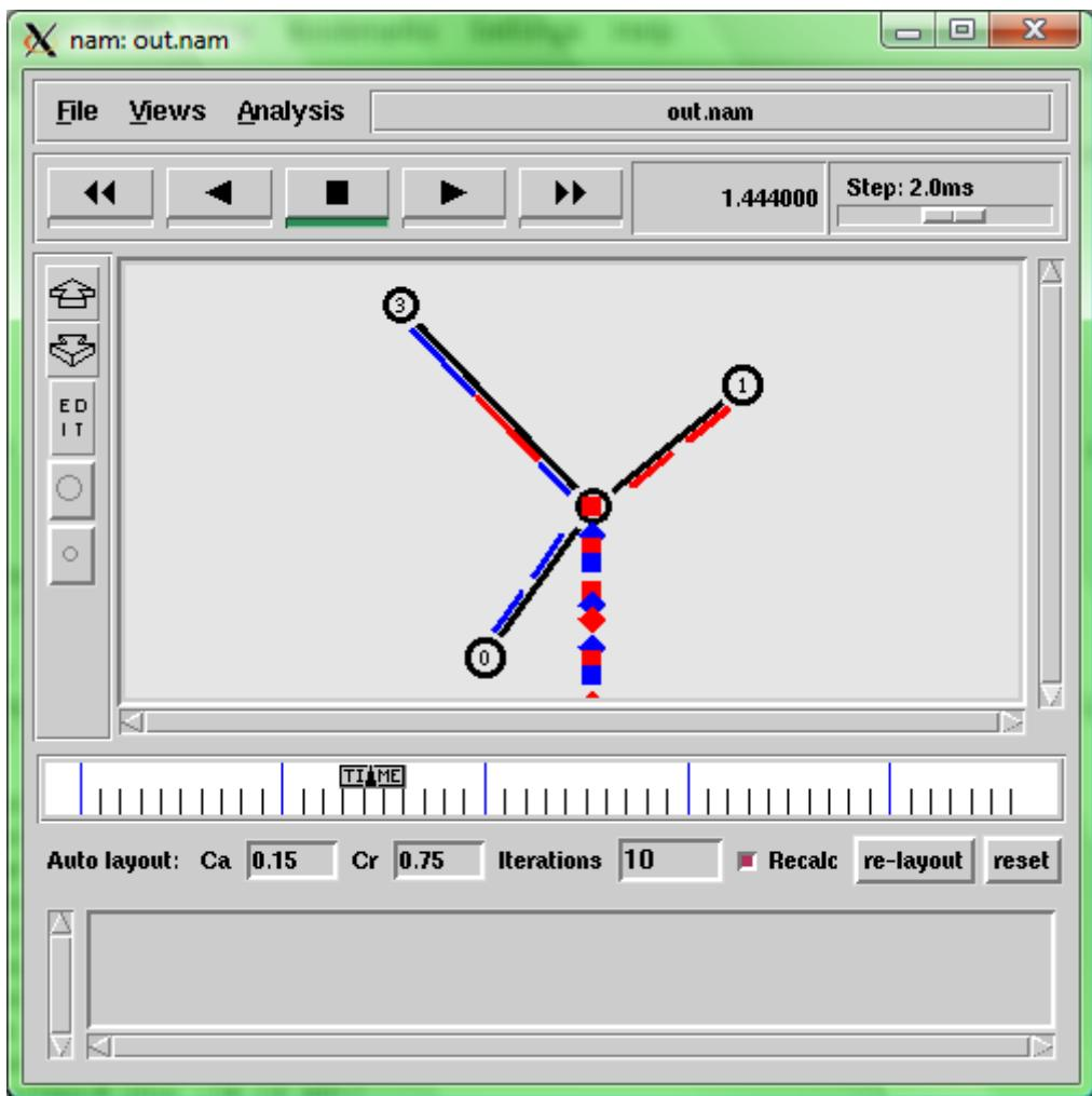
Avec la discipline SFQ, un paquet sur deux qui est rejeté, provient du flux UDP 0 et un sur deux provient du flux UDP 1. Comme 37,5% des paquets sont toujours perdus, environ 2 paquets sur 3 sont reçus par le nœud 3 pour chaque flux.
