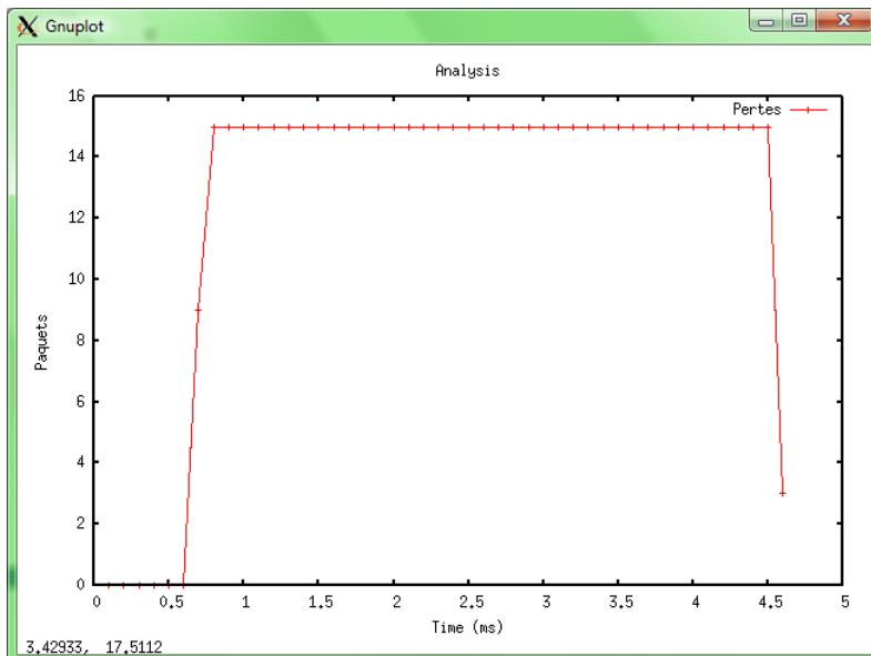
On remarque que l'analyse des données avec un traitement externe est plus précis : même si on a quelques différences au niveau du débit (dépassement des 1Mbps
